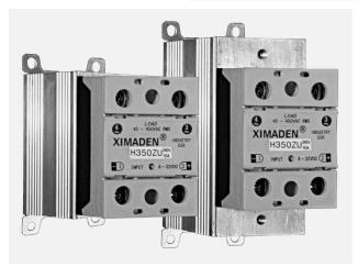
XIMADEN U 系列固态继电器采用了安全防护一体化的设计。外形美观大方,两只反并联的晶闸管不仅提高了 dV/dT 等指标,更因为双 SCR 管芯的散热面积大,所以具有工作电流大,耐浪涌冲击,可靠性高的特点。此外,内置的抑制变频器干扰的大容量阻容吸收器(RC 回路),独特的强力电力端子和配套的 DIN 导轨散热器,突出了产品的设计风格。
